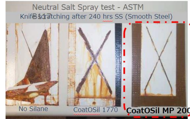
著しく不良 不良 良好
